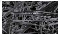
「ジャケットオペーク」に採用している ガラスファイバー
