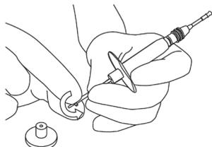
②新しいプランジャーを差し込み、固定ネジとプランジャーヘッドを締め付ける。
